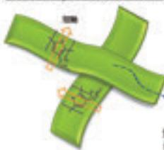
高分子有機半導体 P3HT のスピコート薄膜が示す**非晶質の構造**を、**分子配向**という視点から詳細に解明しました。
