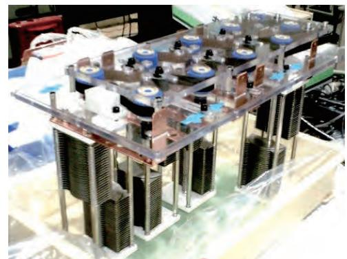
図1:開発したRF共振回路
