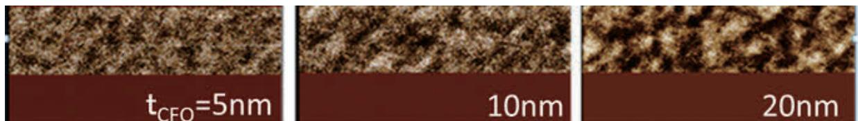
図 3 :  $\text{Al}_2\text{O}_3(0001)/\text{Pt}(111)/\text{CoFe}_2\text{O}_4(t_{\text{CFO}})$  超薄膜の MFM による磁気像。図中の数字は  $\text{CoFe}_2\text{O}_4$  層の膜厚を示す。スケールは横幅が  $3\mu\text{m}$ 。
