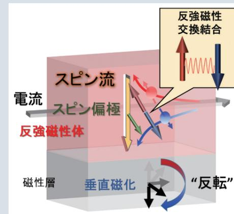
反強磁性体中で生成されたスピノ流を使った、隣接磁性層の磁化反転の様子
