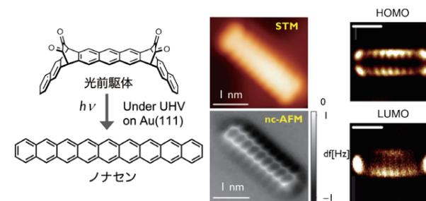
図2 光前駆体に可視光を照射する『前駆体法』で合成した高次アゼン(ノナゼン)分子の、STMおよびAFMで測定した分子イメージとHOMOおよびLUMOの分子軌道イメージ。
