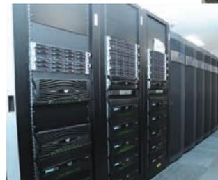
▲ 手前に共有メモリ型サーバ (主にゲノム解析に利用)、奥にクラスター型サーバ (化学計算などに利用) を設置。
