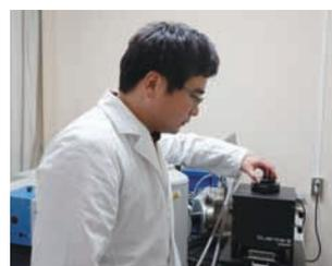
◀合成したナノ粒子の光学特性を蛍光光度計により評価する筆者。
