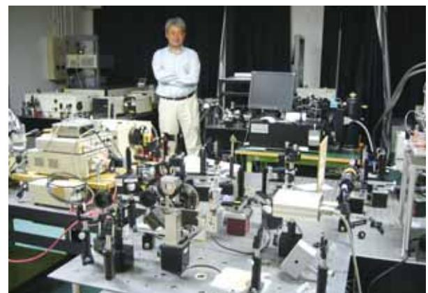
10兆分の1秒という、超短単一パルス幅で照射できる高出力のフェムト秒レーザー装置が各種装備されている金光研究室。各部屋や装置ごとに得られる出力も多岐にわたり、一つの分子やナノ粒子に狙いを定める光学分光実験を幅広く行える研究環境が整っている。
