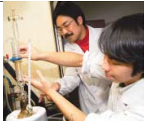
手前は、試行錯誤の末、ナノ微粒子の表面にシリカ(SiO 2 )をうまく被覆する方法を編み出した森本泰正さん(修士課程2年生)。しかし被覆したシリカは熱処理後に取り除かれる。その分、微粒子のサイズを小さくできるからである。この山本助手(後方)の「用済み後に取り除く」という発想は非常にオリジナリティが高い。
