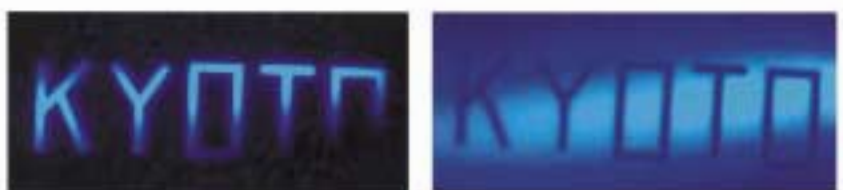
微細加工によりアルゴンイオンビーム照射領域をパターン化したチタン酸ストロンチウムのカソードルミネッセンス 左: KYOTOの文字領域をアルゴンイオンビームで照射、KYOTOの文字が青色に発光。一文字、約50マイクロメートル。 右: KYOTOの文字領域をマスクして背景領域をアルゴンイオンビームで照射、KYOTOの文字部分のみが発光していない。
