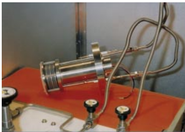
電磁シールドルーム内に置かれたガスシンチレーション検出器
