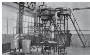
1939年頃、喜多研究室にて研究されていた人造石油合成試験装置の一部
