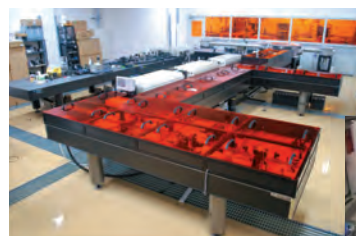
高い出力安定性と稼働率を誇る 超高強度極短パルスレーザー 装置T 6 レーザー
