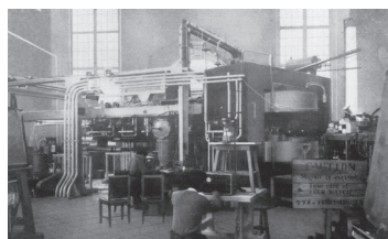
旧蹴上発電所内に設置されたサイクロトロンは1955年に完成
