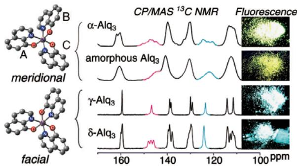
有機EL発光材料(Alq<sub>3</sub>)の固体NMRスペクトル。meridional体とfacial体の異性体状態の違いにより発光波長が変化する。
