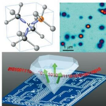
(左上図)ダイヤモンド中のNV中心 (右上図)単一NV中心の共焦点顕微鏡像
