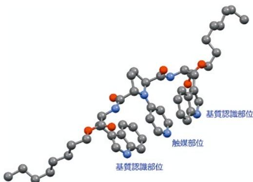
糖類の位置選択的アシル化触媒。本来、反応性の低い水酸基上でのアシル化を選択的に起こし、配糖体天然物の超短段階全合成を可能にする。
