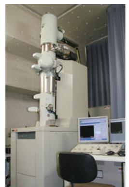
**収差補正透過電子顕微鏡 JEM-2200FS**
