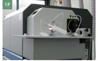
**二重収束型高分解能ICP質量分析装置**
