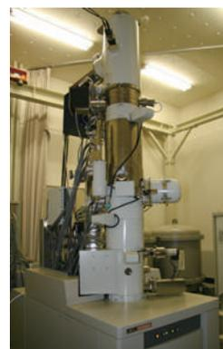
**収差補正走査型透過電子顕微鏡 JEM-9980TKP1**
