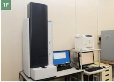
**マトリックス支援レーザー脱離イオン化飛行時間型質量分析計**
