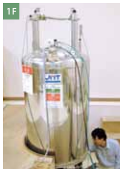
溶液用 核磁気共鳴装置 JEOL ECA600
