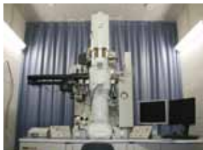
極低温電子顕微鏡 JEM-2100F(G5)
