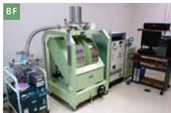
BF 振動試料型磁力計 VSM-5-20 型
