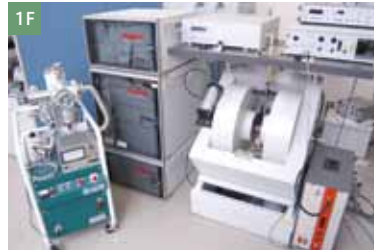
電子スピン共鳴装置 Bruker EMX 8/2.7 型
