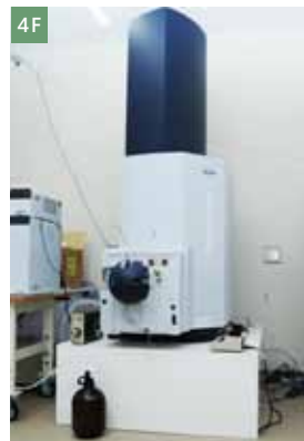
4F 超高分解能 ESI-UHR-TOF/MS システム フルカー・ダルトニクス社 impactHD-KC
