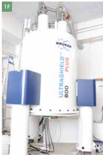
1F 多目的超高磁場核磁気共鳴装置 Avance III 800US Plus NMR System
