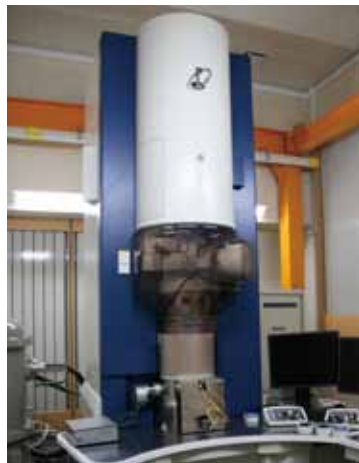
モノクロメータ搭載原子分解能分析 電子顕微鏡 JEM-ARM200F
