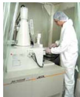
電子ビーム 露光装置 JEOL JBX-5000SF
