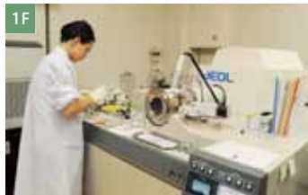
1F 二重収束質量分析装置 MStation JMS-700V
