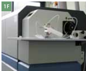
1F 二重収束型高分解能 ICP 質量分析装置 Finnigan ELEMENT2, Thermo Fisher
