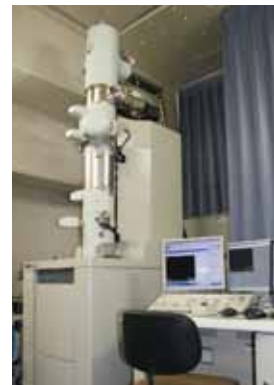
収差補正透過電子顕微鏡 JEM-2200FS
