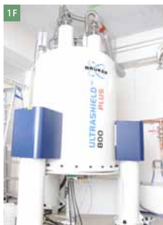
多目的超高磁場核磁気共鳴装置 Avance III 800US Plus NMR System 800 MHz NMR. 溶液および固体測定が可能。5 mm \phi ^1\text{H}/^{109}\text{Ag} \sim ^{31}\text{P} 多核種プローブ、5 mm \phi ^1\text{H}/^{13}\text{C}, ^{15}\text{N} トリプルインバースプローブ、10 mm \phi ^1\text{H}/^{109}\text{Ag} \sim ^{31}\text{P} 多核種プローブ、3 重共鳴 CP/MAS プローブ、高速回転型 CP/MAS プローブが利用可能。温度可変可能。
