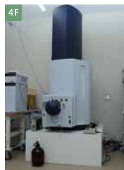
超高分解能 ESI-UHR-TOF/MS システム ブルカーダルトニクス社 impactHD-KC 四重極飛行時間型方式の質量分析部を持つ質量分析計で、イオン化法として、ESI および APCI を用いることができる。 m/z 25,000 までの質量が測定可能で、2.0 ppm の質量精度、38,000 の質量分解能を持ち、極めて迅速に精密質量まで求めることができる。MS/MS 分析、LC-MS 分析も可能である。
