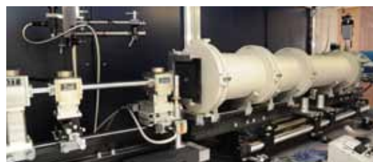
ナノスケール動的構造評価 X 線システム 小角 X 線散乱測定装置 Nano-Viewer 多層膜ミラーにより集光された高輝度 X 線を試料に照射し、得られる回折 / 散乱強度を光子計数式半導体二次元検出器で迅速にデジタルデータ化、さらに付属のソフトウェアにより構造評価を行うシステム。試料環境を操作するための様々なアタッチメントを備えている。
