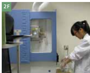
超高分解能 ESI-UHR-TOF/MS システム ブルカーダルトニクス社 impactHD-KC 四重極飛行時間型方式の質量分析部を持つ質量分析計で、イオン化法として、ESI および APCI を用いることができる。 m/z 25,000 までの質量が測定可能で、2.0 ppm の質量精度、38,000 の質量分解能を持ち、極めて迅速に精密質量まで求めることができる。MS/MS 分析、LC-MS 分析も可能である。
