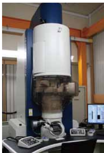
モノクロメータ搭載原子分解能分析電子顕微鏡 JEM-ARM200F 球面収差補正装置による原子分解能像観察や、電子エネルギー損失分光装置とエネルギー分散型 X 線分光装置による元素マッピングを行うことができる分析電子顕微鏡。電子線のエネルギーを単色化することで、高エネルギー分解能のスペクトル測定も可能である。
