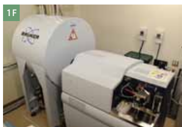
多目的高精度質量分析計 Bruker solarix 本装置は 7 テスラの超電導磁石を備えた Qh-FT-ICR-Mass で 1 attmol 量のイオンを検出できる感度と 100 万分の 1 の質量差を検出できる超高分解能が特徴である。ESI と MALDI イオン源を有し、ナノ LC と GC によるクロマト分析が行える。
