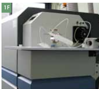
二重収束型高分解能 ICP 質量分析装置 Finnigan ELEMENT2, Thermo Fisher 世界でもっとも高感度かつ高精度な微量元素分析システム。目的元素をアルゴンプラズマでイオン化、二重収束型質量分析装置（分解能 300～10,000）で妨害イオンと分離し、測定する。70 種以上の元素について、ppq ( 10^{-15} ) レベルまでの多元素同時定量が可能である。
