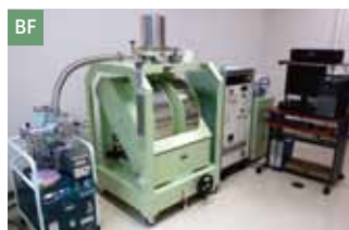
振動試料型磁力計 VSM-5-20 型 物質の磁気的性質の中で最も基本的な磁化特性を評価する装置。最大印加磁場 2 T の電磁石を搭載し、 1 \times 10^{-5} emu の感度で安定した測定が可能。真空中およびガス雰囲気中で広範囲（77～1200 K）な温度制御が可能であり汎用性に優れる。
