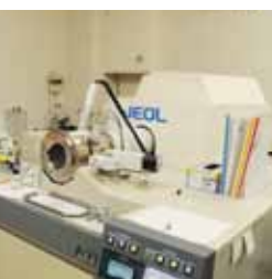
二重収束質量分析装置 MSStation JMS-700V イオン光学系が、磁場・電場から構成される逆配置二重収束型質量分析計で、イオン化法として、FAB および EI を用いることができる。最大分解能は 60,000 で、高分解能測定により組成式も明らかにできる。2,400 ダルトン以上の質量範囲をもつ。イオン源および各種パラメータのオートチューニング機能を搭載している。
