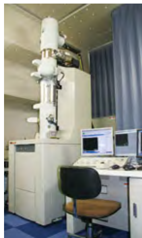
収差補正透過電子顕微鏡 JEM-2200FS
