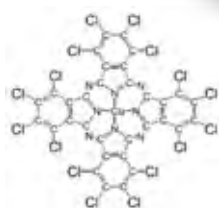
塩素置換したフタロシアニン銅薄膜結晶の円環明視野像と分子構造
