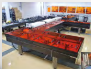
高い出力安定性と稼働率を誇る超高強度極短パルスレーザー装置T6-レーザー
