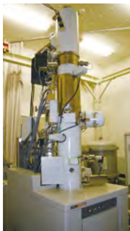
収差補正走査型透過電子顕微鏡 JEM-9980TKP1
