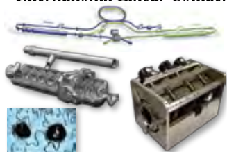
強度変調型永久六極磁石はパルス中性子の集束を可能とする。
