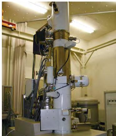
収差補正走査型透過電子顕微鏡 JEM-9980TKP1
