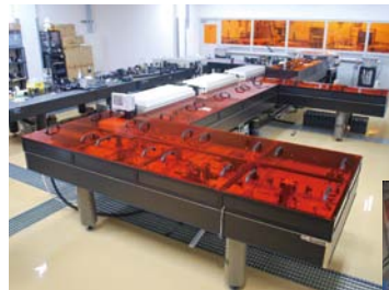
高い出力安定性と稼働率を誇る 超高強度極短パルスレーザー装置T 6 -レーザー
