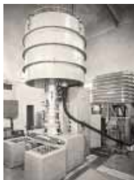
化学研究所が宇治地区へ統合移転するきっかけとなった1968年設置の超高压電子顕微鏡
