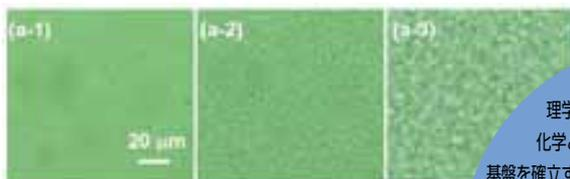
高分子電解質水溶液の相分離過程
