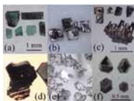
2~5万気圧・1000℃で育成された(a)  $(VO)_2P_2O_7$ 、(b)  $BiMnO_3$ 、(c)  $PrNiO_3$ 、(d)  $Ca_{1.9}Na_{0.1}CuO_2Cl_2$ 、(e)  $CaFeO_3$ 、(f)  $SrCo_6O_{11}$ の結晶および(g)酸素欠損を含む $SrTiO_3$ の青色発光
