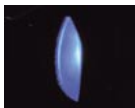
図2 酸素欠損を含む \text{SrTiO}_3 単結晶からの青色発光
