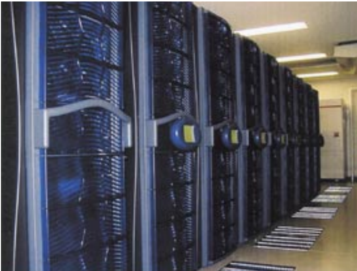
計算化学サーバーと計算生物学サーバー (SGI Origin 3800) スーパーコンピューター
