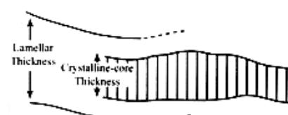
エチレンと一酸化炭素の完全交互共重合体であるpoly(3-oxotrimethylene)の横向きラメラ結晶(溶液からKI結晶上にエピタキシー成長させたもの)の高分解能電子顕微鏡像と、その模式図。結晶芯厚さがラメラ厚さの半分程度であることを示している。
