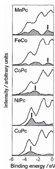
M<sub>n</sub>Pc (M=Mn, Fe, Co, Ni, Cu; Pc=フタロシアニン) 薄膜の逆光電子スペクトル。ZnPcを標準物質とした差スペクトル(ハッティング領域)が中心金属による空状態電子密度を明瞭に反映し、太線で示した軌道の系統的なエネルギー変化は顕著である。
