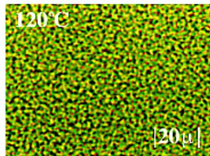
PETの結晶化の光学顕微鏡写真。鎖セグメントの平行配向化によるスピノダル分解型のミクロ相分離構造。
