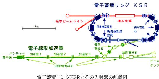
電子蓄積リングKSRとその入射器の配置図
