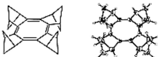
平面に固定されたシクロオクタテトラエンとX線結晶構造図
