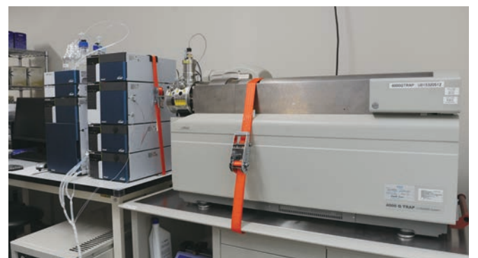
山口研究室で使用されている質量分析装置。数十 pg あれば、化合物の検出は可能。(1 pg = 10 -12 g)
