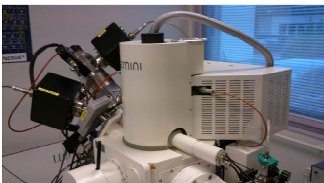
渡航先で使用されていた研究装置。集束イオンビームを用いてタングステンなどの高融点金属の細線を作製ができる。
