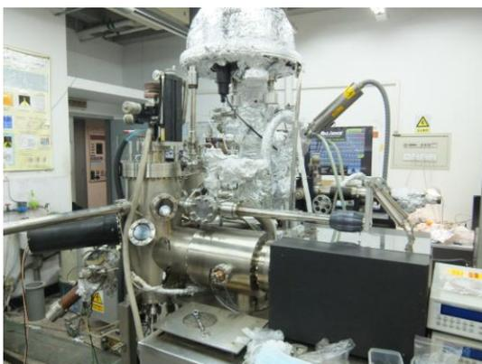
渡航先で主に使用されていた研究装置。分子エピタキシー法で薄膜を成長させ *in situ* で測定をおこなえる。
