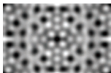
塩素置換したフタロシアニン銅薄膜結晶の円環明視野像と分子構造
