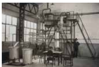
1939年頃、喜多研究室にて研究されていた ガソリン合成試験装置の一部
