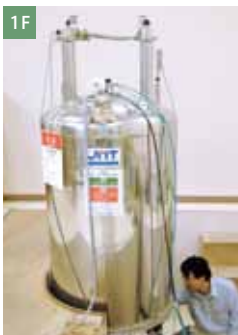
溶液用 核磁気共鳴装置 JEOL ECA600
