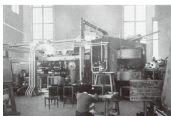
旧蹴上発電所内に設置されたサイクロトロンは 1955年に完成
