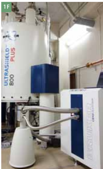
多目的超高磁場核磁気共鳴装置 Avance III 800US Plus NMR System
